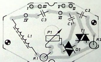
Bild 4. Ansicht der bestückten Platine des Lichtdimmers
